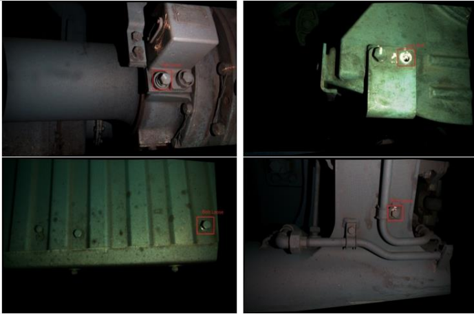
图9 螺栓缺陷识别结果图
